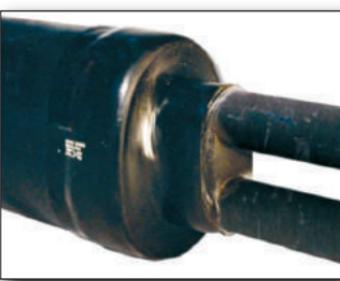
Lice zaduženo za polaganje cevi je odgovorno za stavljanje završnih kapa pre priključivanja na cevovod objekta. Te kape treba zaštiti od vatre, ne smeju se seći i nisu podobne za naknadnu montažu. Zazidavanje cevnih završetaka bez završne kape (EK) nije dozvoljeno.
