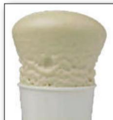
**Isoplus** principijelno koristi 100% bezfreonski i samim tim ekološki ciklopitan kojim pokreće PUR-penu. To znači da pri ogromnom svojstvu toplotne izolacije istovremeno poseduje najmanje moguće ODP i GWP-vrednosti. ODP (potencijal razgradnje ozona) = 0, GWP (potencijal efekta staklene baštice) = 0!
