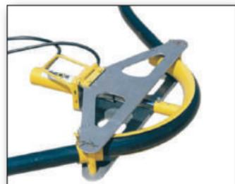
Korišćenje neprikladnog alata za savijanje nije dozvoljeno. Da bi se sprečila oštećenja fleksibilnih cevi, nije dozvoljeno savijanje oko ivica, drugih vodova, greda, ivica objekata i zidova.
