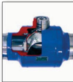
Jednokratni-kuglični ventili, odnosno kuglični ventili za priključivanje po potrebi, služe kao završetak nekog dela trase koji će biti nastavljen u nekom kasnjem, još nepoznatom, trenutku. Zavaren kao završni deo, postojeća **isoplus**-trasa može u svakom trenutku biti nastavljena bez pražnjenja cevovoda i isključivanja pogona.
