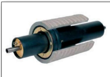
Gumeni prstenovi, odnosno umeci, služe za sprečavanje izlivanja vode prilikom prolaza kroz zidove građevina i komora. Instalater je odgovoran za navlačenje gumenog prstena i centriranje u prolazu kroz zid pre priključivanja za cevovd objekta.
