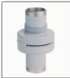
Uredaj za bušenje pod pritiskom služi za izradu cevnog priključka kod **isoplus**-cevovoda koji se nalazi u funkciji. Priprema, sprovođenje i izrada bušotine u skladu sa AGFW-radnim listom FW 432. Pri tome se između nominalne veličine glavnog voda i grane prema AGFW FW 401 mora napraviti razlika od barem dve dimenzije.
