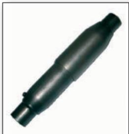
**EKO** (jednokratni kompenzator) – sistem služi za termičko prednaprezanje **isoplus**-cevovoda kod već zatrpanih kanala cevovoda. Delovi trase između EKO-sistema moraju biti zatrpani, a samo neophodni montažni šahrt za EKO-sistem ostaje otvoren. Po pravilu, sledi termičko prednaprezanje sa postojećim pogonskim medijumom, međutim ono može takođe biti izvršeno i uz pomoć mobilnih zagrevnih agregata.
