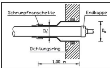
Zaptivanje priključne cevi se vrši pomoću tehnički neophodnog prolaza kroz zid (strana **Z 6.0**) koji ne spada u obim isporuke.
