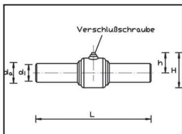
**Materijal:** Kućište i zavareni završeci od St 37.0, radni materijal br. 1. 0254, kugla i vratilo od hrom-niklovanog čelika, prsten i zaptivači od PTFE.
