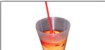
26. Neophodnu količinu pene treba uliti u otvor za punjenje spojnica penom. Ili ubaciti levak maštine za pravljenje pene i uključiti na odgovarajuću veličinu spojnice podešen automatizovan postupak punjenja.
