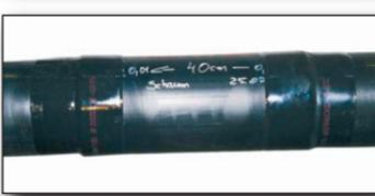
Montaža PE-klizajuće spojnice kao prave vezne spojnice važi i za redukcione i završne spojnice sa 'cevnom čaurom'.
